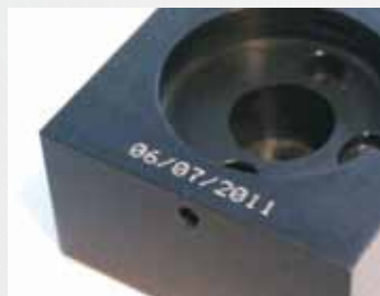
Dati codificati su componenti in alluminio anodizzato
