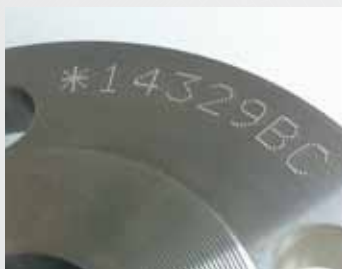
Numerazione seriale su parti in acciaio
