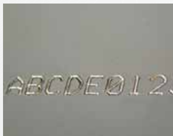
Marcatura profonda su acciaio verniciato
